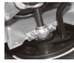
Dvojité masivní uložení ložiska nápravy převodovky
