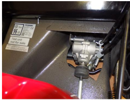
Pohon sekačky je zajištěn pomocí kardanu
