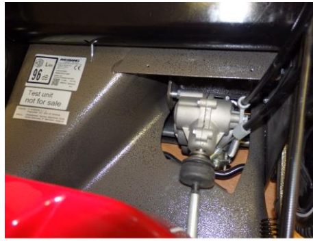
Pohon sekačky je zajištěn pomocí kardanu
