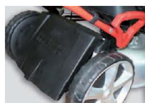
nastavení deflektoru pro zadní výhoz
