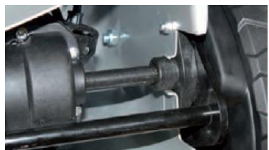
masivní uchycení přední a zadní nápravy pomocí šroubů
