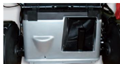
zadní výhoz do koše s mulčovací záslepkou
